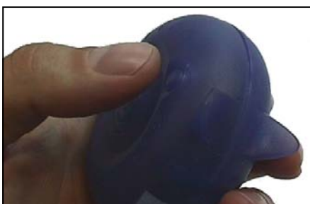
Wählschalter ein/aus/Ausdruck auf der Rückseite des Gerätes
