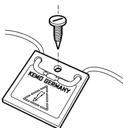
**D** | Mit einer Blechschiene werden die Hochspannungsplättchen im Motorraum befestigt. Der Schraubenkopf darf nicht die Hochspannungs-Metallfläche auf den Plättchen berühren.
