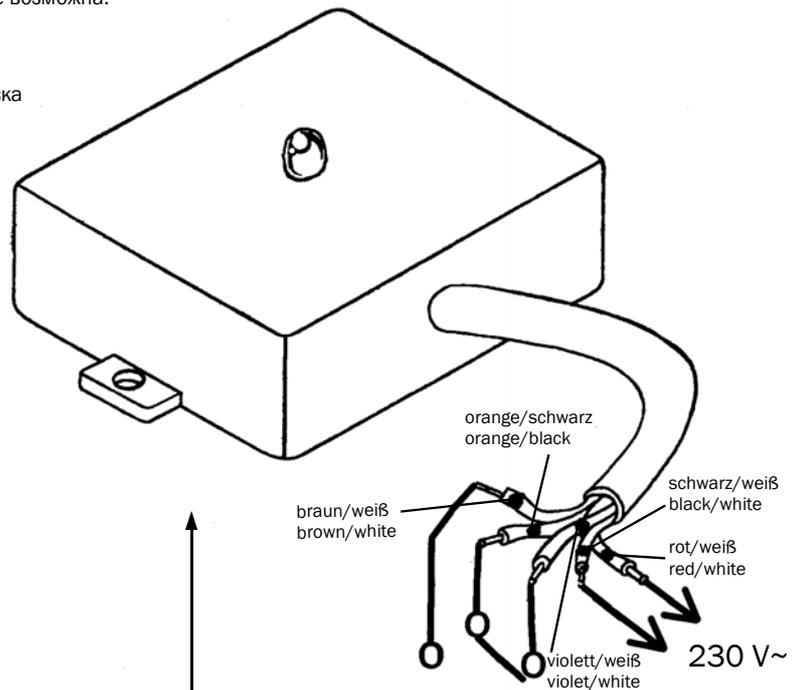
Anschlussbelegung und Stellung des eingebauten Relaiskontakts bei Tageslicht.
