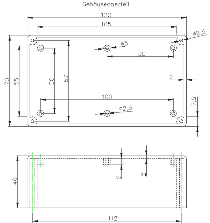
Gehäuseunterteil und Oberteil schwarz mit innenliegenden Befestigungsmöglichkeiten für Platinen im Gehäuseoberteil sowie im Gehäuseunterteil.
