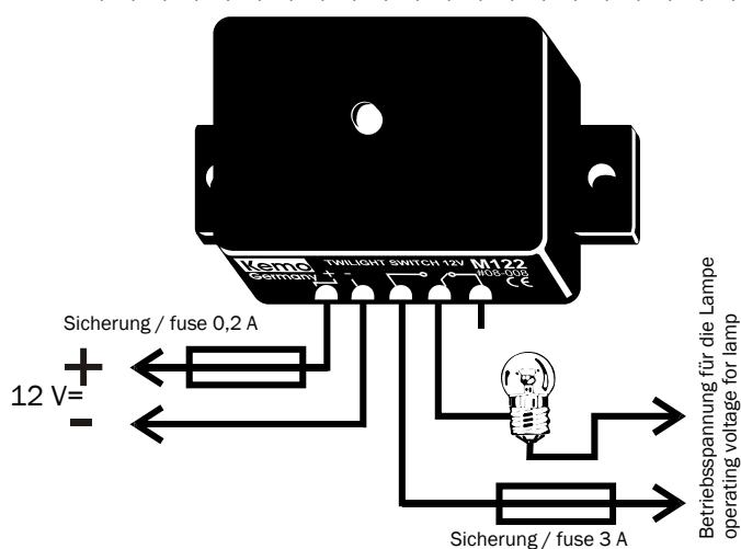
Einschalten der Lampe bei Eintritt der Dämmerung, Ausschalten der Lampe bei Tageslicht
